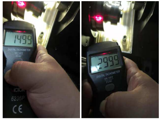
图9 试验转速测试现场
